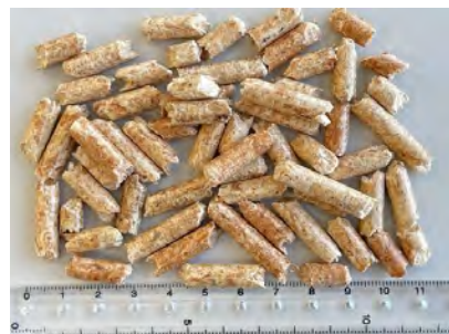
2022年から木質燃料へ変更 (木製品工場で発生した 木質の残材を固めた物)
