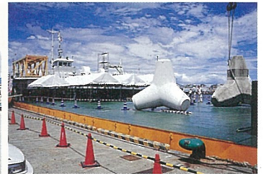
クレーン船に展示された消波ブロック
