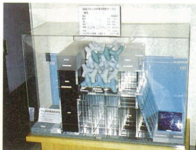
消波ブロック内蔵双胴型ケーソン模型
