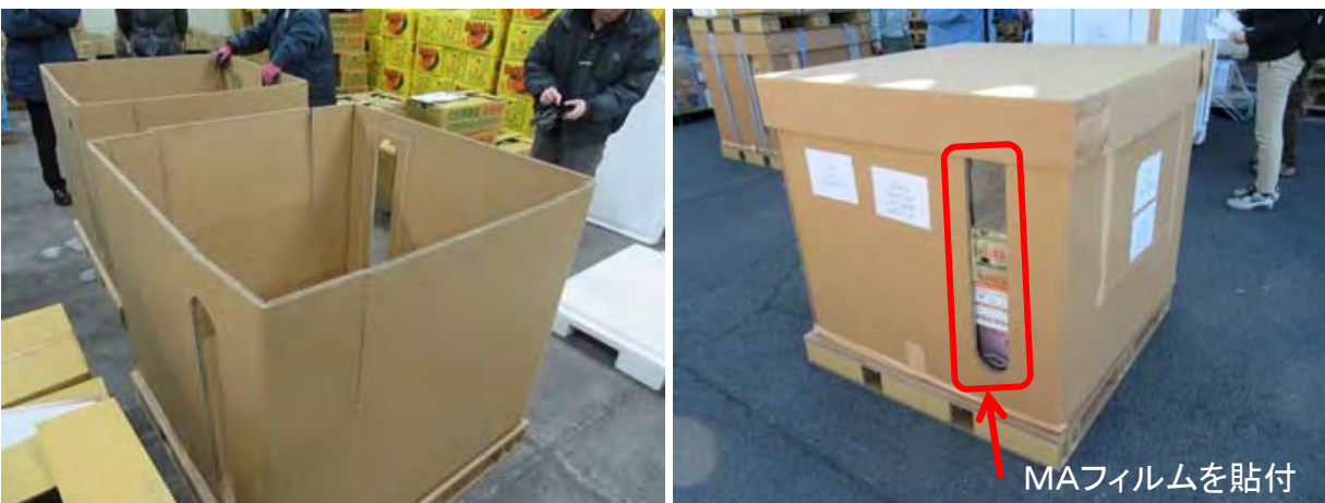
鮮度保持BOXの試作(左:組み立て中、右:農産物梱包後)
