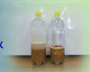
図7 今回新たに作成した液状化の体験装置
