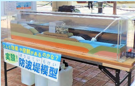
模型を使った防波堤の効果実験
